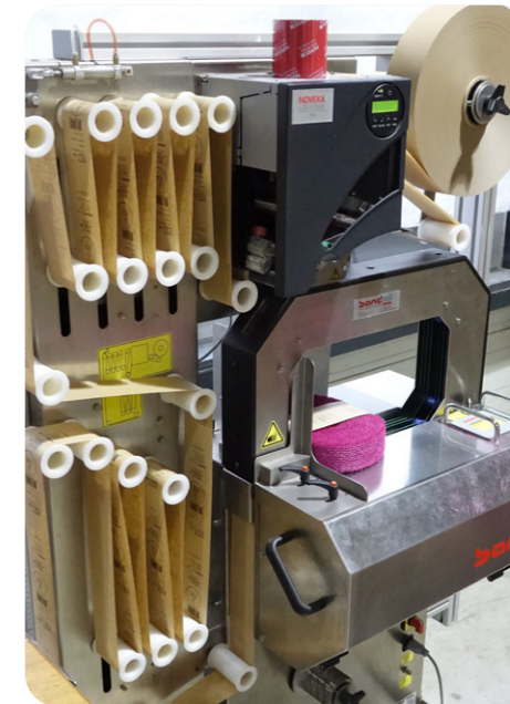
La machine Bandall avec, à gauche, le système tampon qui garantit la continuité du processus de banderolage.
