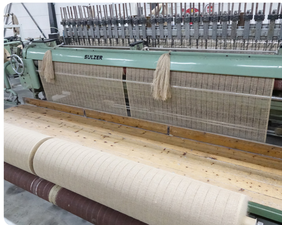
Le hall de production de Zwartz contient de nombreuses machines à tisser qui produisent quotidiennement différents articles en toile de jute, d'une largeur de 3 à 520 cm
